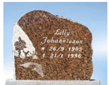
5.6 Vånga – röd granit Polerad front. Vitmålad, nedsänkt text cirka 5 mm. Polerad, upphöjd dekor på efterhuggen botten. Råhuggna kanter. Mod. 264, B 60, H 59, Text 23U.
